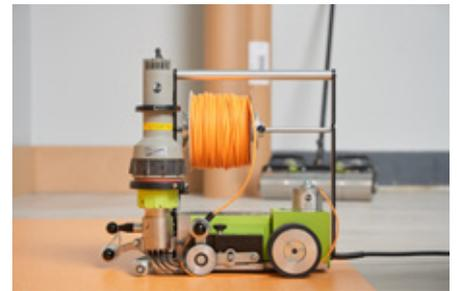
5. Die Verarbeitungstemperatur liegt bei 350–400 °C (bei noracare<sup>®</sup> max. 300 °C). Beim Verarbeiten der Thermoschnur mit Schweißautomaten ist die Geschwindigkeit auf ca. 2 lfm/Min. einzustellen. Die Laufgeschwindigkeit und Temperatureinstellung kann bei den meisten Automaten reguliert werden.
