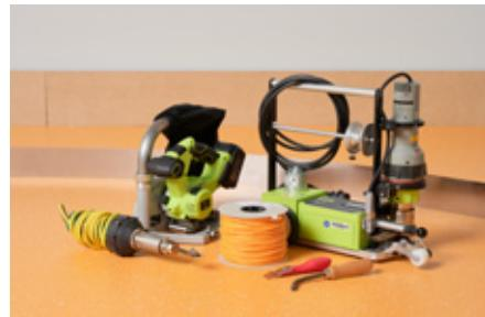
1. 使用手工开槽器和/或开槽机，让接缝位于刀具中间位置进行切割或开槽。
