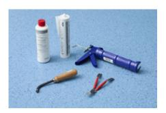
1. Nahtbereich mit nora® Flüssigwachs einwachsen. Wachs unbedingt komplett abtrocknen lassen!
