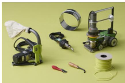
1. Les joints sont fraisés au centre ou fraisés à la fraiseuse de joints (gouge).
