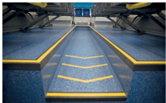
Treppenkanten mit Signalstreifen
